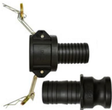
Камлок – это система универсальных самоблокирующихся быстроразъёмных соединений кулачкового типа, которая позволяет мгновенно соединить несколько шлангов (рукавов) между собой. Устройство кулачков муфты обеспечивает устойчивое к вибрации соединение с адаптером без использования дополнительного фиксирующего шплита или других приспособлений.
