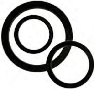
Кольцо резиновое уплотнительное прямоугольного сечения для камлока - материал NBR (нитрил бутадиен каучук – соответствует ГОСТ 7338-90 для прокладок из пластины резиновой листовой типа I. Работоспособны при  $t^{\circ}$  от  $-30^{\circ}\text{C}$  до  $+80^{\circ}\text{C}$ . При повышенной температуре ускоряется старение, материал твердеет и становится хрупким (при отсутствии кислорода, например, в горячем масле, процесс старения значительно замедляется).
