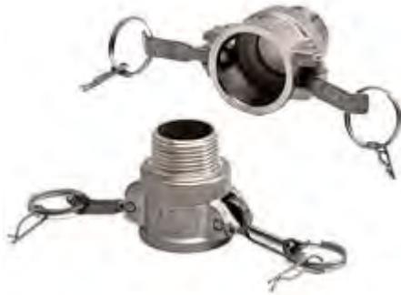
Камлок – это система универсальных самоблокирующихся быстроразъёмных соединений кулачкового типа, которая позволяет мгновенно соединить несколько шлангов (рукавов) между собой, присоединить шланг к различным устройствам и резервуарам, заглушить концы шлангов и адаптеров специальными грязепылезащитными колпаками и т.д. Устройство кулачков муфты обеспечивает устойчивое к вибрации соединение с адаптером без использования дополнительного фиксирующего шплинта
